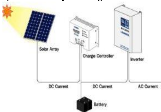
Gambar 2. Sistem Energi Surya Fotovoltaik Sumber: Widayana, 2012
