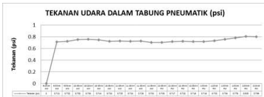
Gambar 8. Grafik Tekanan Dalam Tabung Membran Atap Panggung Inflatable
