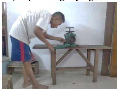
Gambar 10. Pekerja di stasiun kerja Rolling Mill
