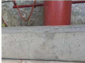
Gambar 3 Benda Uji setelah paparan suhu 400°C
