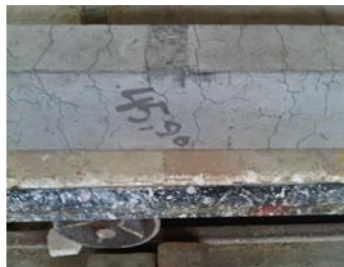
Gambar 4 Benda Uji setelah paparan suhu 600°C
