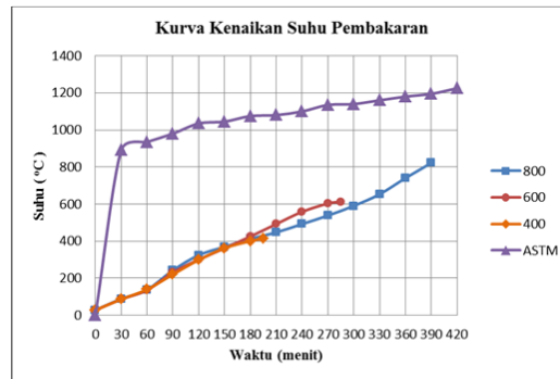
Gambar 1 Kurva kenaikan suhu pembakaran
