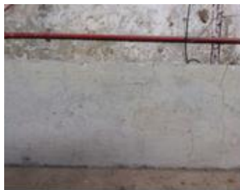
Gambar 5 Benda Uji setelah paparan suhu 800°C
