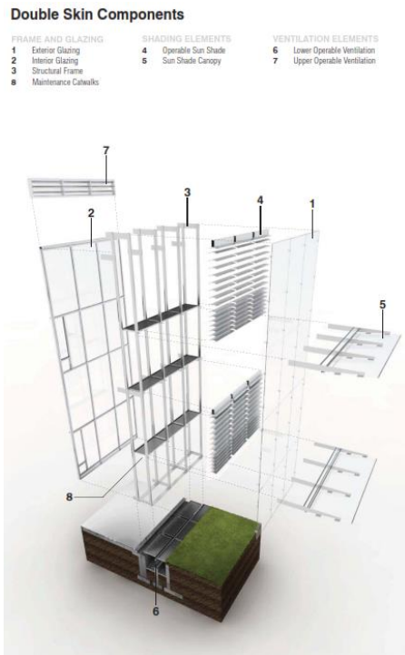
Gambar 3. Ilustrasi komponen pada double-skin facade dengan material kaca
