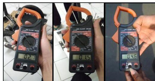
Gambar 3.3 Pengukuran Arus dengan Ampere Meter
