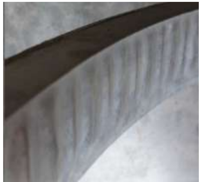
Gambar 4 Wrinkling yang terjadi pada proses roll bending [5]
