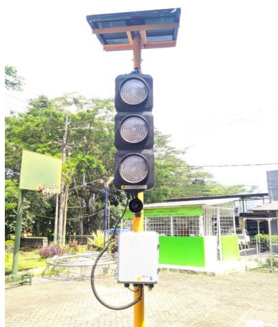
Gambar 13. Hasil produk PT.AMI lampu lalu lintas berbasis solar cell
