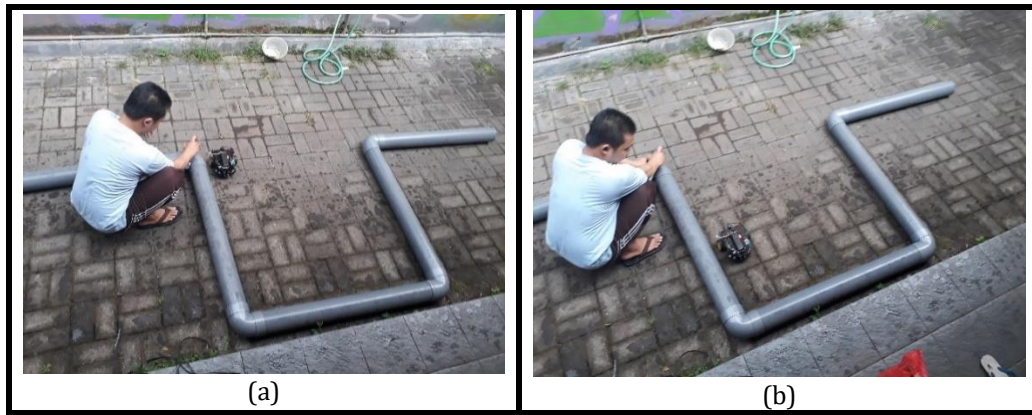
Gambar 7. (a) Robot Berhasil Mendeteksi Gas (b) Robot Gagal Mendeteksi Gas
